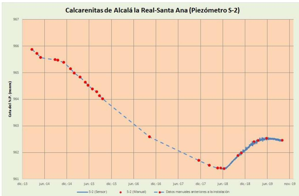
Figura 8: Evolución piezométrica en S-2 (datalogger)
