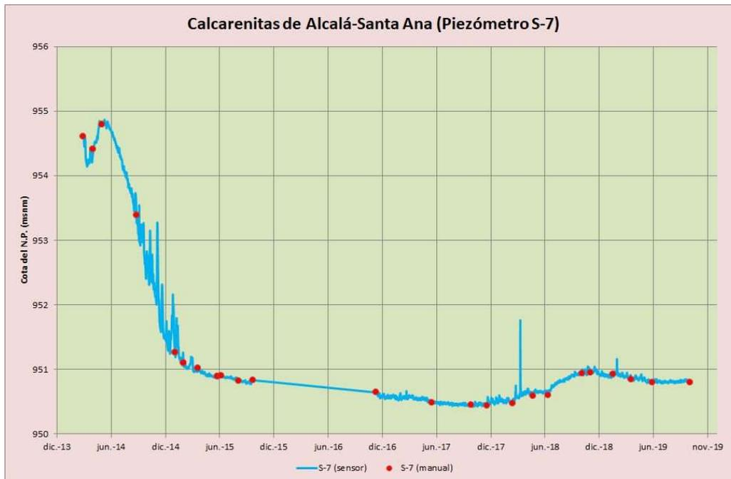
Figura 7: Evolución piezométrica en S-7 (datalogger).
